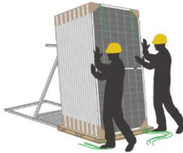
(8) قم بقطع أحزمة التعبئة المتبقية بحيث تستقر الوحدات على داعم الحامل.
