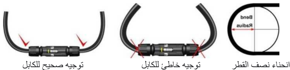
الشكل 4: التوجيه الصحيح والحد الأدنى لانحناء نصف القطر للكابلات.
