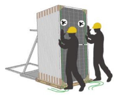
(7) عندما يتبقى 1-2 من أحزمة التعبئة الرأسية، ادفع الوحدة برفق لإمالتها نحو داعم الحامل.
